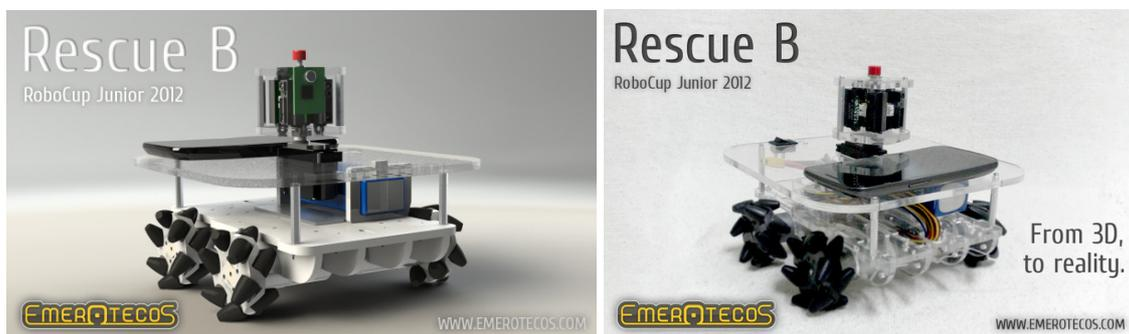
**Figura 4. Projeto mecânico (esquerda) e protótipo (direita) do robô feito pela Emerotecos em 2012.**
