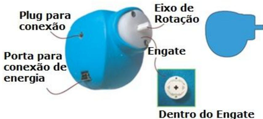
Figura 3: Motor com firmware modificado.
