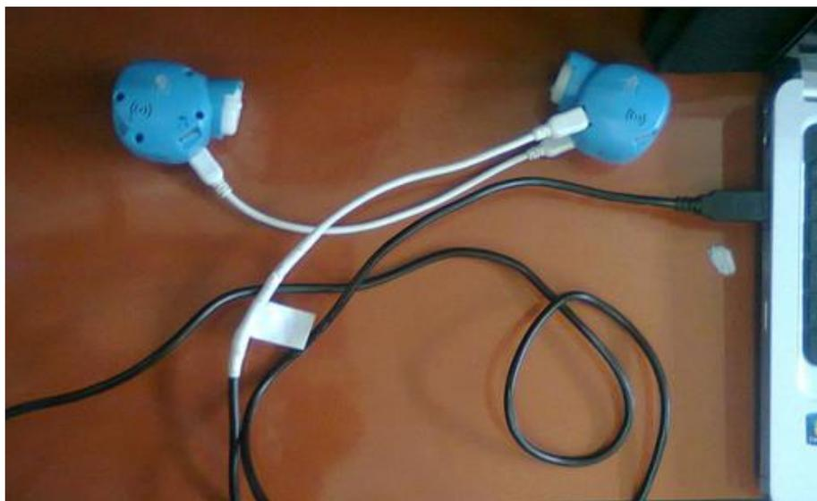
**Figura 11: Comunicação entre o computador e o motor rainha por meio do serial gateway.**
