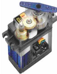
**Figura 5. Servomotor e sua estrutura interna**
