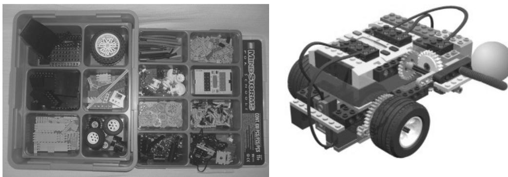
**Figura 1:** Kit LEGO Mindstorms® 9793 com RCX e um exemplo de montagem.
