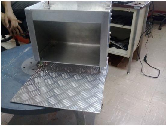
Figura 1: Vista del Chasis y del Depósito de Latas
