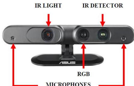
Fig. 6. Parte frontal de la cámara ASUS Xtion PRO LIVE, se destaca la cámara RGB, el detector IR, la luz IR y los micrófonos.
