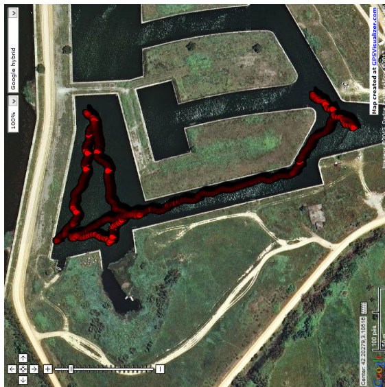
Fig. 6. Trajeto real realizado pelo robô aferido através de DGPS ( ground truth )
