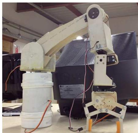
Fig. 1. Protótipo do robô com o punho e a garra em PVC.
